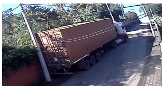
Figura 120: Exemplo de situação crítica, com caminhão com excesso de peso ancorado em poste (foto do acervo da UGMT)
