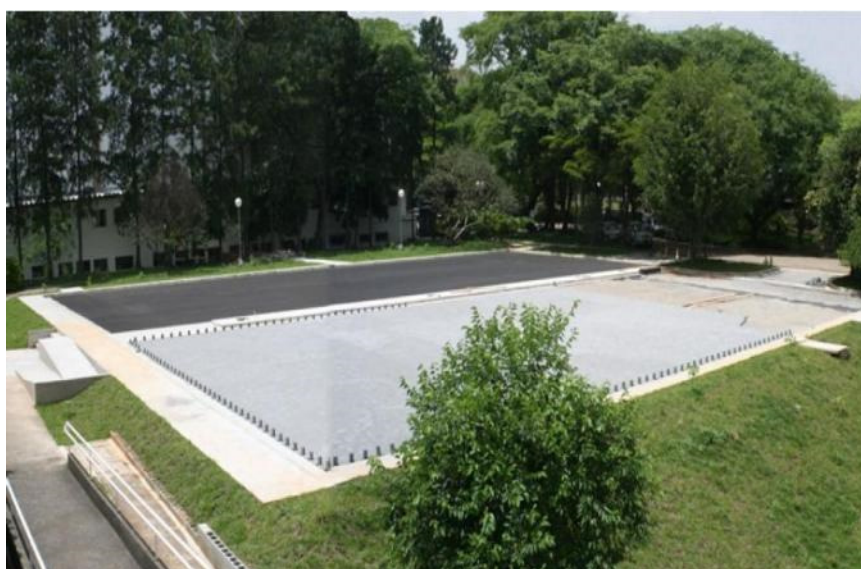
Figura 7.23 - Bloco de concreto permeável e concreto poroso asfáltico no Laboratório CTH
