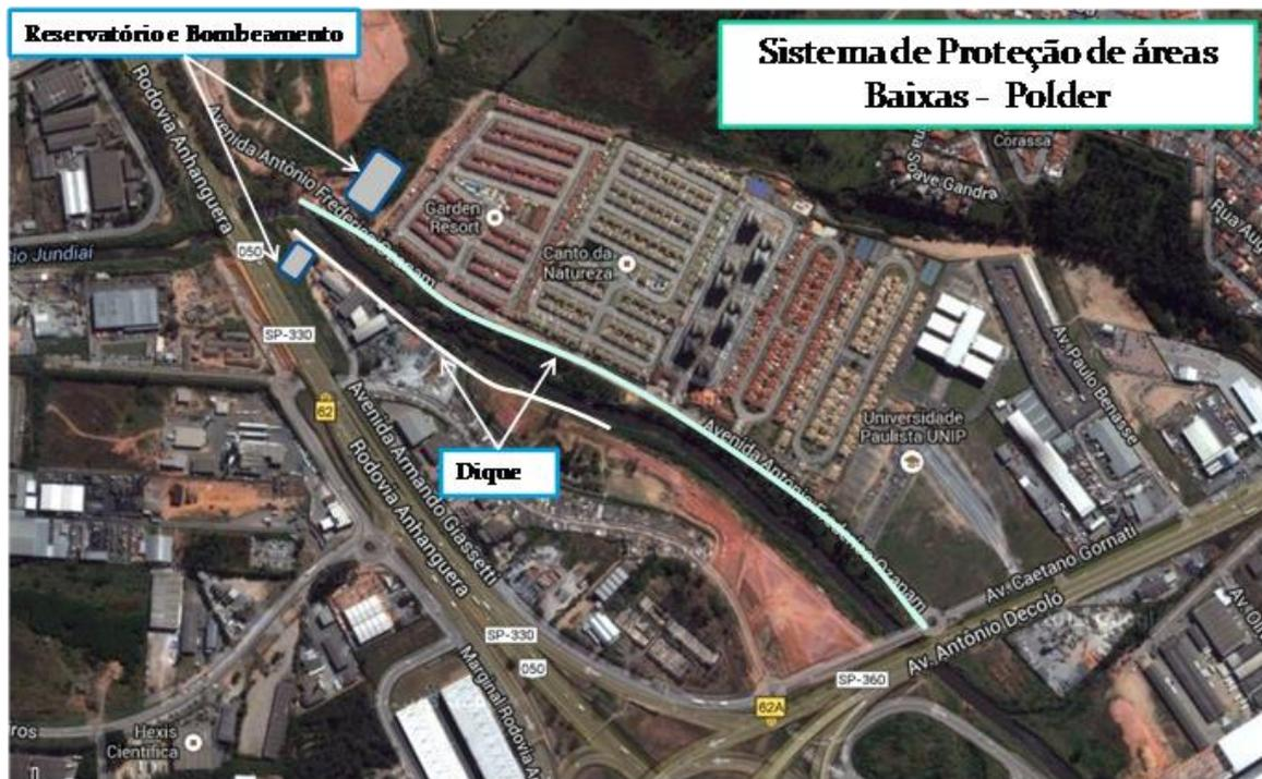
**Figura 6.6 – Área de intervenção dos pôlderes da margem esquerda e direita**
